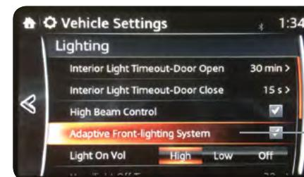
El AFLS PUEDE SER APAGADO UTILIZANDO LA CONFIGURACIÓN EN MAZDA CONNECT™
