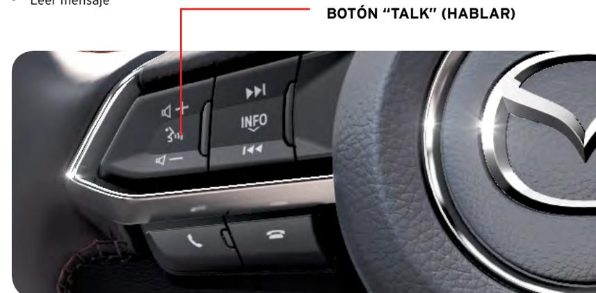
La operación del sistema de audio puede llevarse a cabo utilizando el comando por voz.
