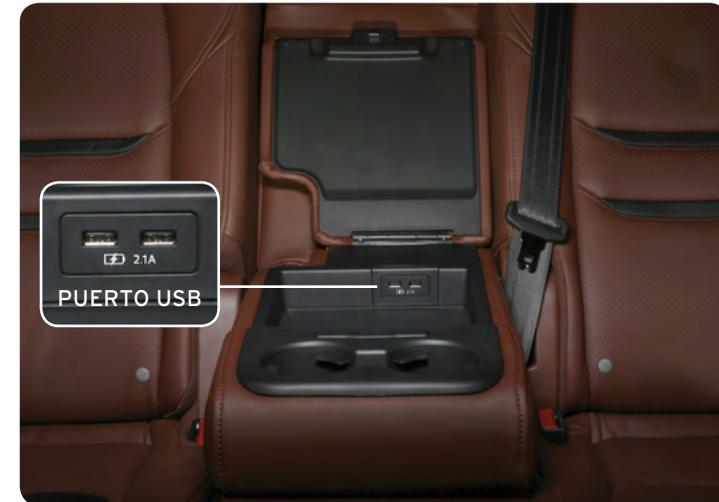
El descansabrazos trasero cuenta con dos puertos USB que te permitirán únicamente cargar la batería de tu teléfono celular, dispositivo de audio, tableta electrónica, etc. Para más información consulta tu manual de propietario.
