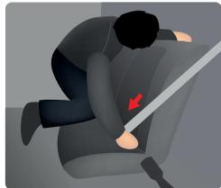
Para lograr un buen ajuste del asiento de seguridad, apoya todo el peso de tu cuerpo y entonces tensa el cinturón de seguridad, controlando que quede correctamente tensado y trabado.
