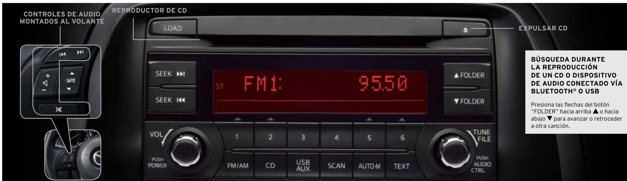
**BÚSQUEDA DURANTE LA REPRODUCCIÓN DE UN CD O DISPOSITIVO DE AUDIO CONECTADO VÍA BLUETOOTH® O USB**
