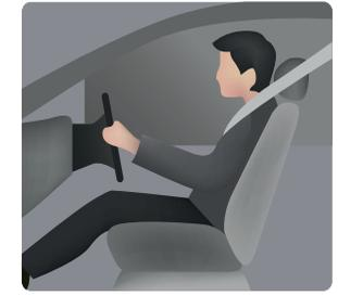
El conductor y acompañante deberán ajustar la posición del asiento delantero lo más atrás posible. El respaldo deberá estar inclinado 1 o 2 posiciones de la vertical y los ocupantes del vehículo deberán estar sentados con la espalda bien apoyada en el respaldo del asiento. Nunca apoyes objetos y evita apoyar brazos o manos sobre la cubierta de la bolsa de aire.
