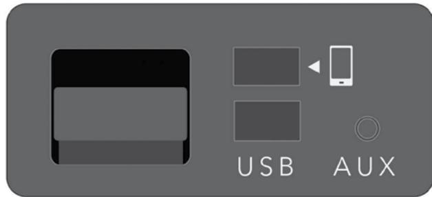
Mazda Connect detectará que se ha conectado un dispositivo compatible. Sigue el aviso en pantalla para habilitar Android Auto™ o CarPlay™. En caso de que el dispositivo compatible con Android Auto™ o CarPlay™ no se reconozca después de haberlo conectado vía USB, desconecta y vuelve a conectar para iniciar nuevamente la conexión.
