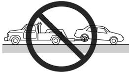
➤ No se debe remolcar con una cadena de suspensión. Esto puede dañar su vehículo. Se debe usar un levantador de rueda o una plataforma.
