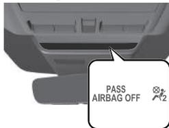
Si los sensores de peso del acompañante están normales, el indicador se enciende cuando la llave de encendido está en ON. La luz se apaga después de algunos segundos. Luego, el indicador se enciende o se apaga en las siguientes condiciones:
