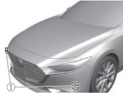
1. Sensor de radar lateral delantero
