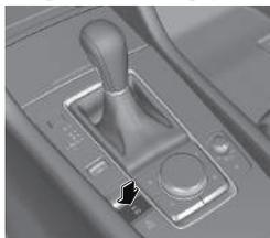
Si se oprime el interruptor EPB sin pisar el pedal de freno, aparecerá un mensaje en la exhibición de multinformación para notificar al conductor que debe pisar el pedal de freno.
