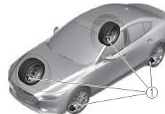
1. Sensores de presión de neumático
