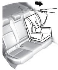
5. Empuje el sistema de seguridad para niños firmemente en el asiento del vehículo. Asegúrese que el cinturón lo apriete bien. Podrá oír ruidos provenientes del retractor al funcionar si el sistema se encuentra en el modo de bloqueo automático. Si el cinturón no sostiene el asiento bien seguro, repita este procedimiento.
