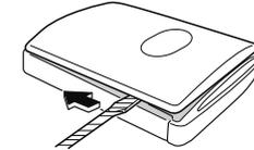
4. Inserte y gire en la dirección de la flecha el destornillador de punta plana y retire la cubierta superior.
