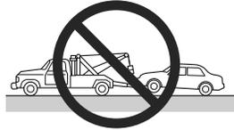
➤ Si no puede soltar el freno de estacionamiento al remolcar el vehículo, transporte el vehículo con todos los neumáticos delanteros y traseros levantados del piso tal como se observa en la figura. Si el vehículo es remolcado sin levantar los neumáticos del piso, el sistema de frenos podría resultar dañado.
