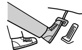
➤ Use calzado apropiado para conducir de manera de evitar que su pie haga contacto con el pedal de frenos al pisar el pedal del acelerador.
