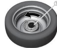
1. Perno de sujeción del neumático de repuesto
